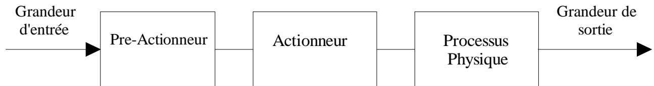
Fig.1-13. Commande en chaîne directe.
